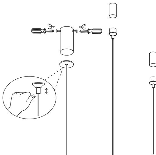
**5** Зафиксируйте втулку на тросе при помощи специального ключа, отрежьте лишний кусок троса и закройте корпус держателя троса крышкой.
